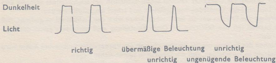
Spannungsverläufe am Ausgang:
